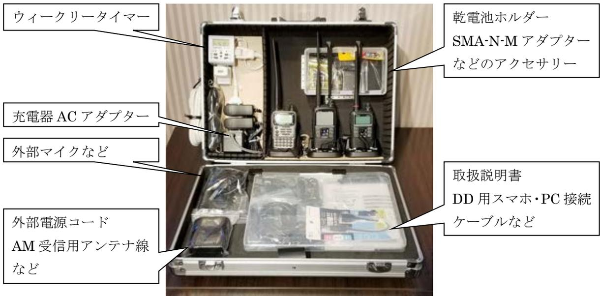
写真6 自動補充電式ハンディ機保管箱の利用例
