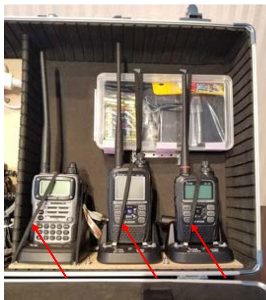
写真4 トランシーバーの脱落防止バンド
