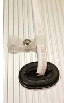
写真5 AC パーツの配置と電源タップをアルミツールケースから貫通させる方法
