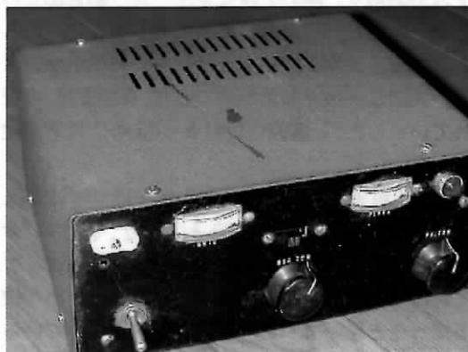
左上のソケットが水晶発振器のソケットです。ケースはトヨムラのTEC-6（キャリアコントロールのAM機）のものでした。
