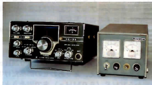
I C-71 トランシーバーと 取説の電源回路をまねて作った安定化電源
