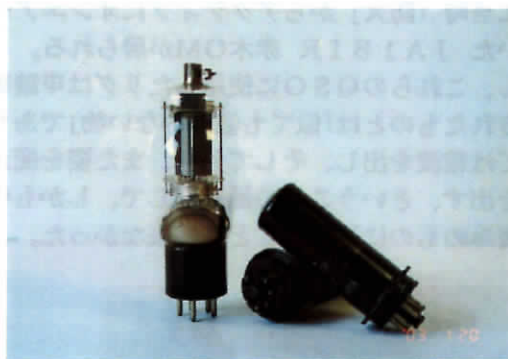
左側がUY-807(左) 右は同等管の1619(直熱管)共にジャンク品
