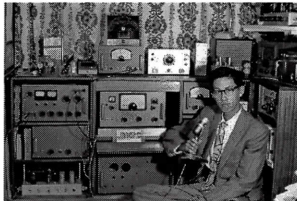
[写真2] (左側3段) 第2世代 HF 3.5~28MHz 無線送信機 (中央) 最初に作った短波帯受信機 (上段左) HF 帯外付け VFO、(上段右) 短波帯のプリアンプ (右) JA1EHC
