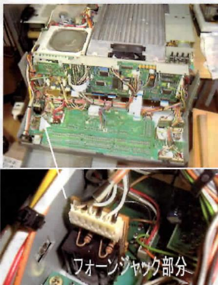
慎重に約2時間かけて割れて不良になったフォンジャックを取り外し、交換し、元に戻してOKとなりました。
